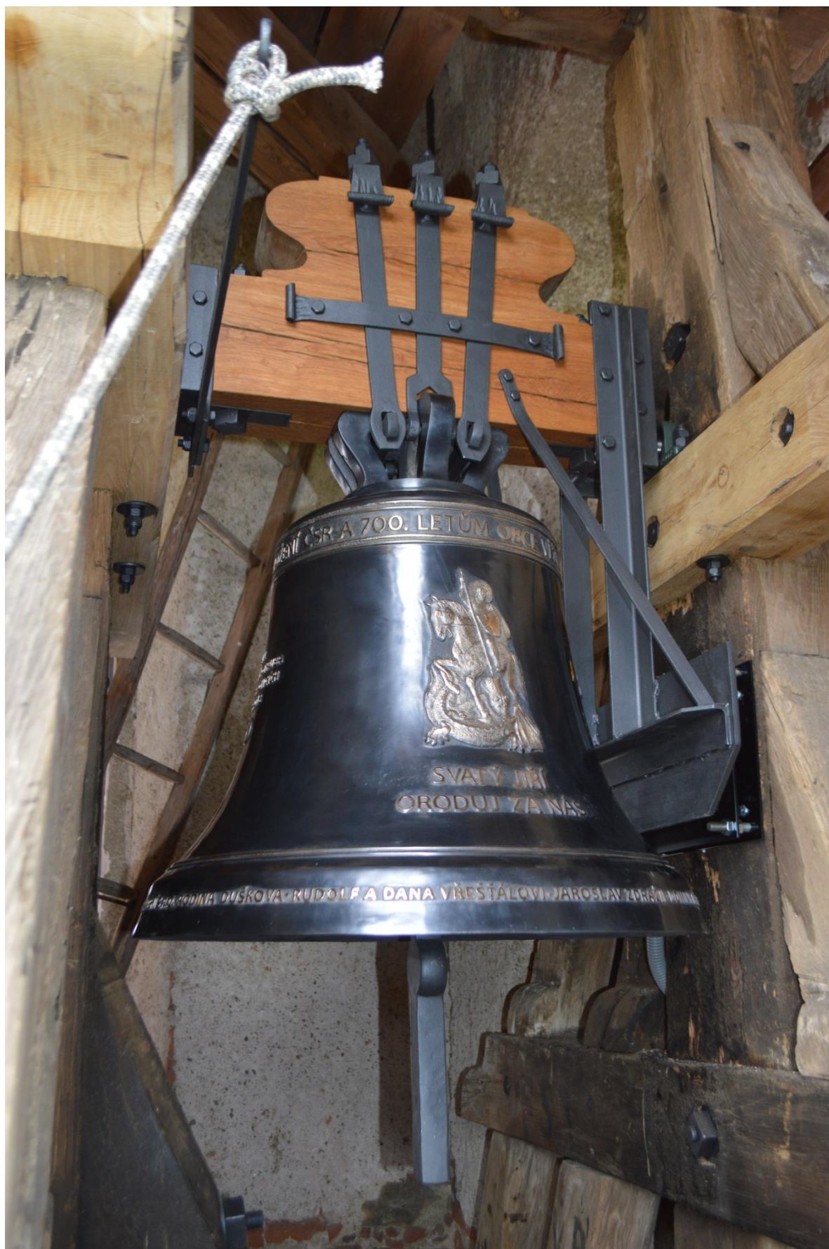
10. Nový zvon včetně technického vybavení a pohonu lineárním motorem
