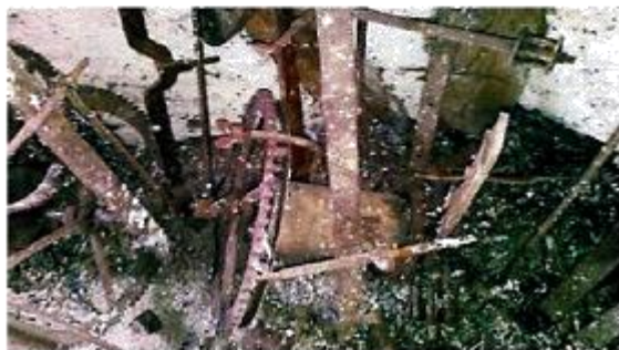
HOLUBÍ TRUS A KORÓZE. Ty hodinový stroj trápily. Takto mechanismus vypadal, když si jej hodinář odvážel z věže kostela.
