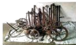
TAK vypadal pomezský hodinový stroj, když byl zcela demontovaný. Foto: Zrc Archiv M. Flossmanna
