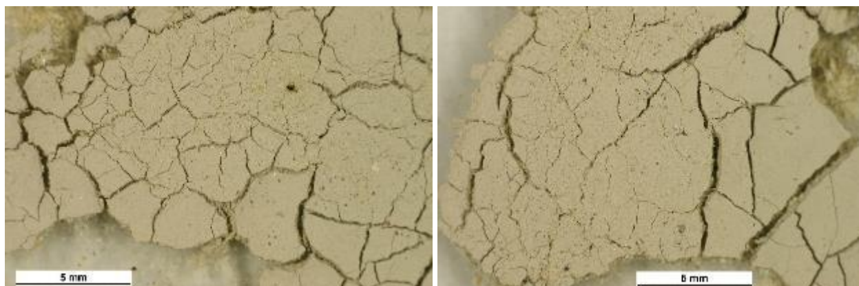
Obr. 8 – jemná (jílovitá, hlinková) frakce v maltě – vzorku č. 2
