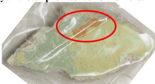
Obr. 2 Místo odběru nátěrových vrstev pro nábrus ze vzorku č. 1
