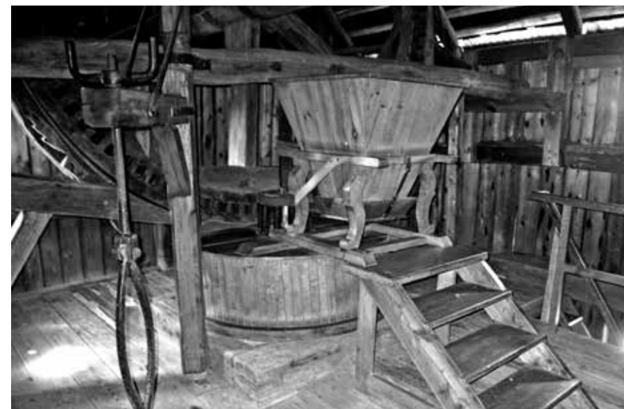
STARÉ ČESKÉ MLÝNSKÉ SLOŽENÍ VE MLÝNĚ NĚMECKÉHO TYPU: NÁSPYKA S KORČÁKEM, LUB S KAMENY, JEŘÁB NA ZVEDÁNÍ KAMENŮ
