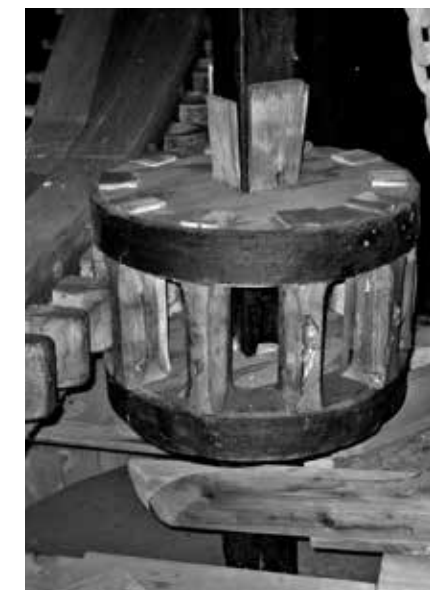
DETAIL PŘEVODU MEZI PALEČNÝM A CÉVOVÝM KOLEM
