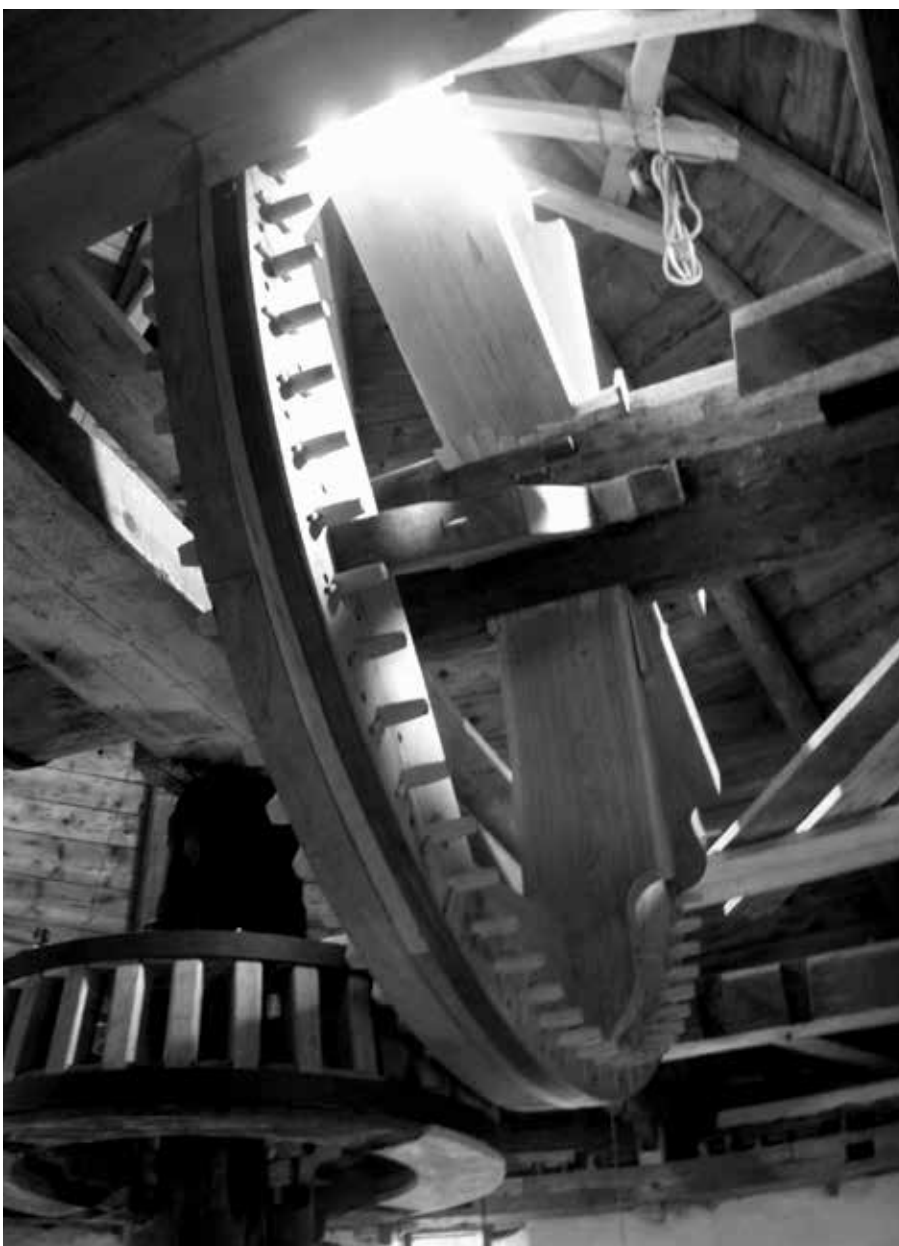
HLAVNÍ HŘÍDEL, PALEČNÉ A CÉVOVÉ KOLO VĚTRNÉHO MLÝNA HOLANDSKÉHO TYPU
