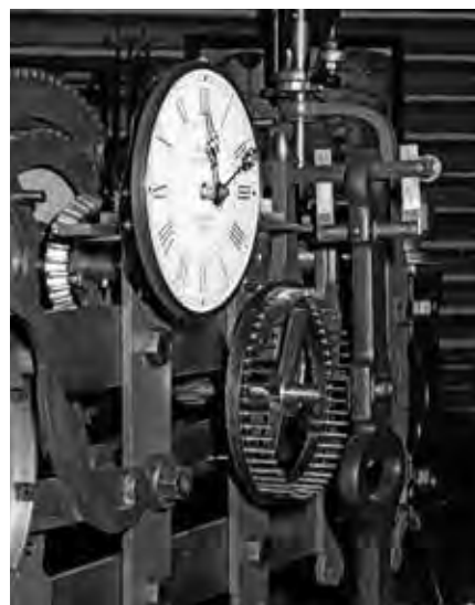
DETAIL TZV. KOLÍČKOVÉHO KROKU NA HODINOVÉM STROJI OD NEZNÁMÉHO VÝROBCE Z ROKU 1898
