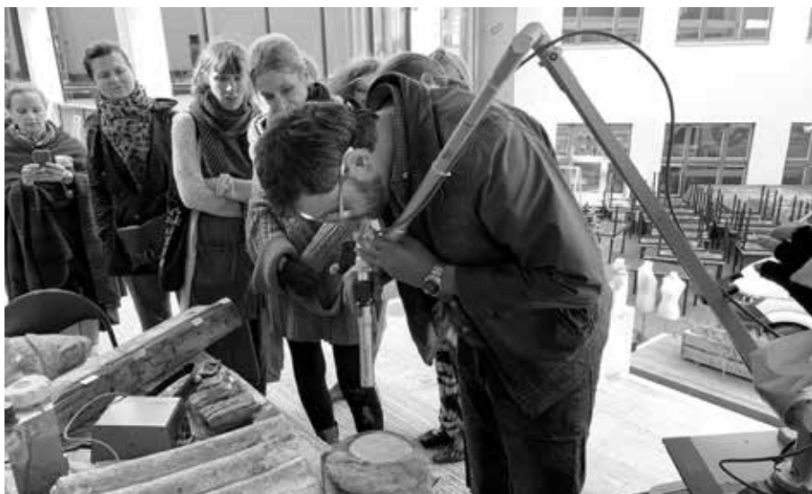
RESTAURÁTOR KAMENE JAKUB ĎOUBAL PŘEDVÁDÍ VYUŽITÍ LASERU NA ODSTRAŇOVÁNÍ NEČISTOT Z POVRCHU KAMENE.
